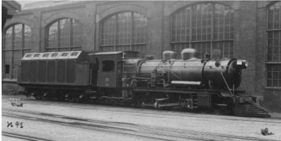
Abb. 6: Die erste Henschel-Kondenslokomotive für Argentinien im Kasseler Werk, 1931
