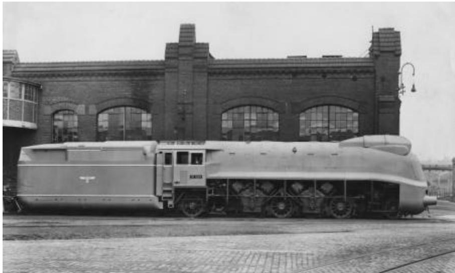
Abb. 8: Henschel-Schnellzuglokomotive Nr. 19 1001 der Reichsbahn mit Einzelachsantrieb durch V-Dampfmotoren, 1941
