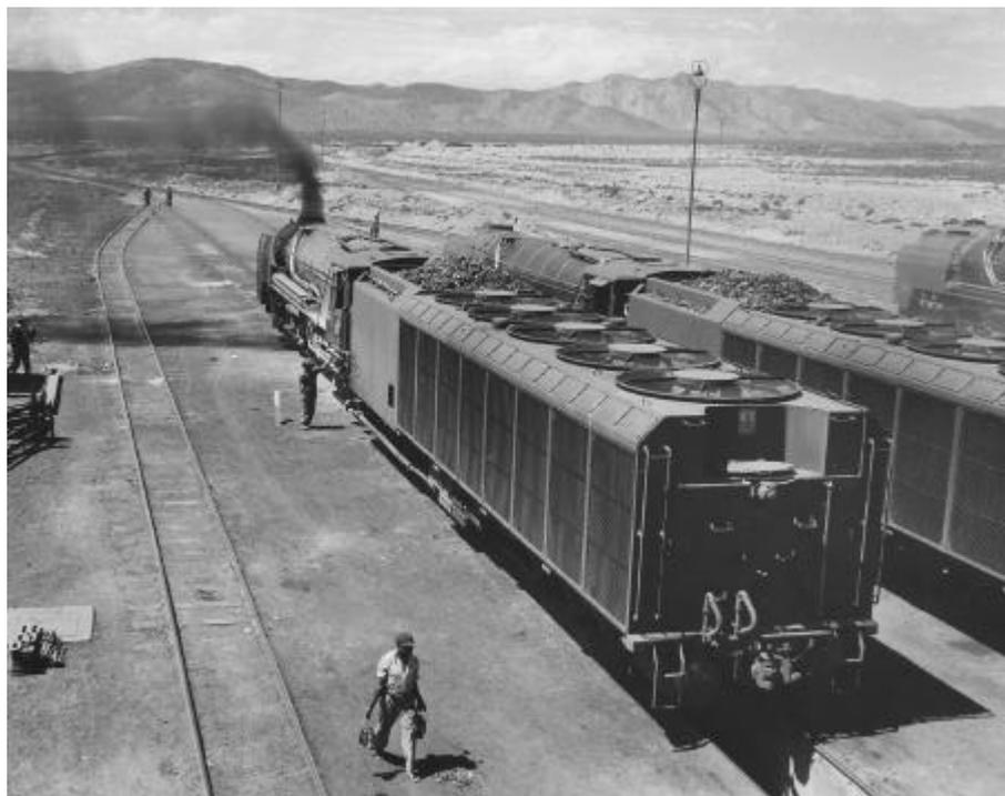
Abb. 9: Zwei Henschel-Kondenslokomotiven im Einsatz durch die Wüste „Karoo“ bei Touws River in Südafrika, um 1965
